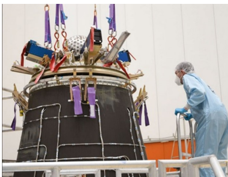
Préparation des passagers de Vega-C. On remarque LARES-2, sphère dotée de réflecteurs laser qui ressemble à une boule de discothèque. Tout autour, les dispositifs rectangulaires de couleur bleue servent à éjecter les Cubesats.
