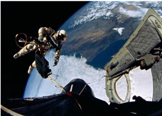
03 Juin 1965 Mission Gemini 4 l'astronaute White sort dans le vide, se déplaçant grâce au HSMU (Hand Held Self Maneuvring Unit), un pistolet à jet de gaz
