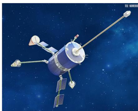
Satellite Gonets : système de télécommunications par satellite russe utilisant une constellation de satellites de télécommunications placés en orbite basse .
