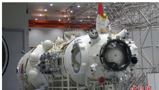
Modèle structurel du module Tianhe de la future spatiale chinoise. © CMSA
