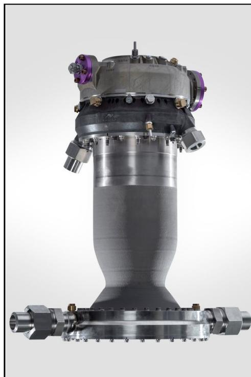
La chambre de combustion en cuivre (au centre de la pièce) est recouverte d'une jaquette en alliage de nickel, réalisée grâce au procédé de projection à froid (cold spray)
