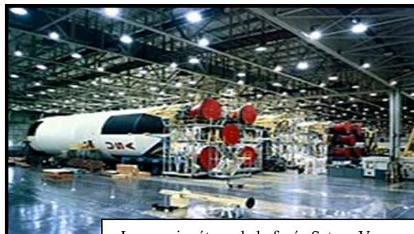
Le premier étage de la fusée Saturn V en cours de construction au centre de Michoud.
