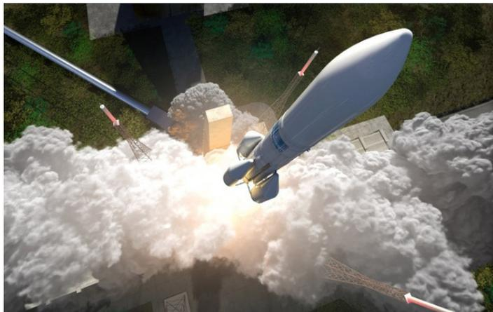
Ariane 6 sera aussi décliné en deux versions, plus « adaptées au marché ». La fusée A62 pourra embraquer jusqu'à 5 tonnes et l'A64 jusqu'à 10,5 tonnes. Ce nouveau lanceur « low cost » ne sera pas le seul à débarquer dans les prochaines années sur les pas de tirs.
